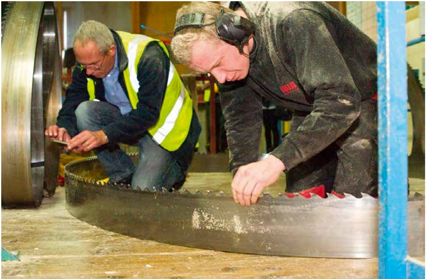
Søren Luja Hansen inspiserer et sagblad og ser spor av slitasje, selv om det er stål mot metal. Hastigheten og trevirket som gnikker skaper en blank sone og den vil han gjerne få til å ligge på et bestemt sted. Når den gjør det, "fungerer" det. Foto: Luja
